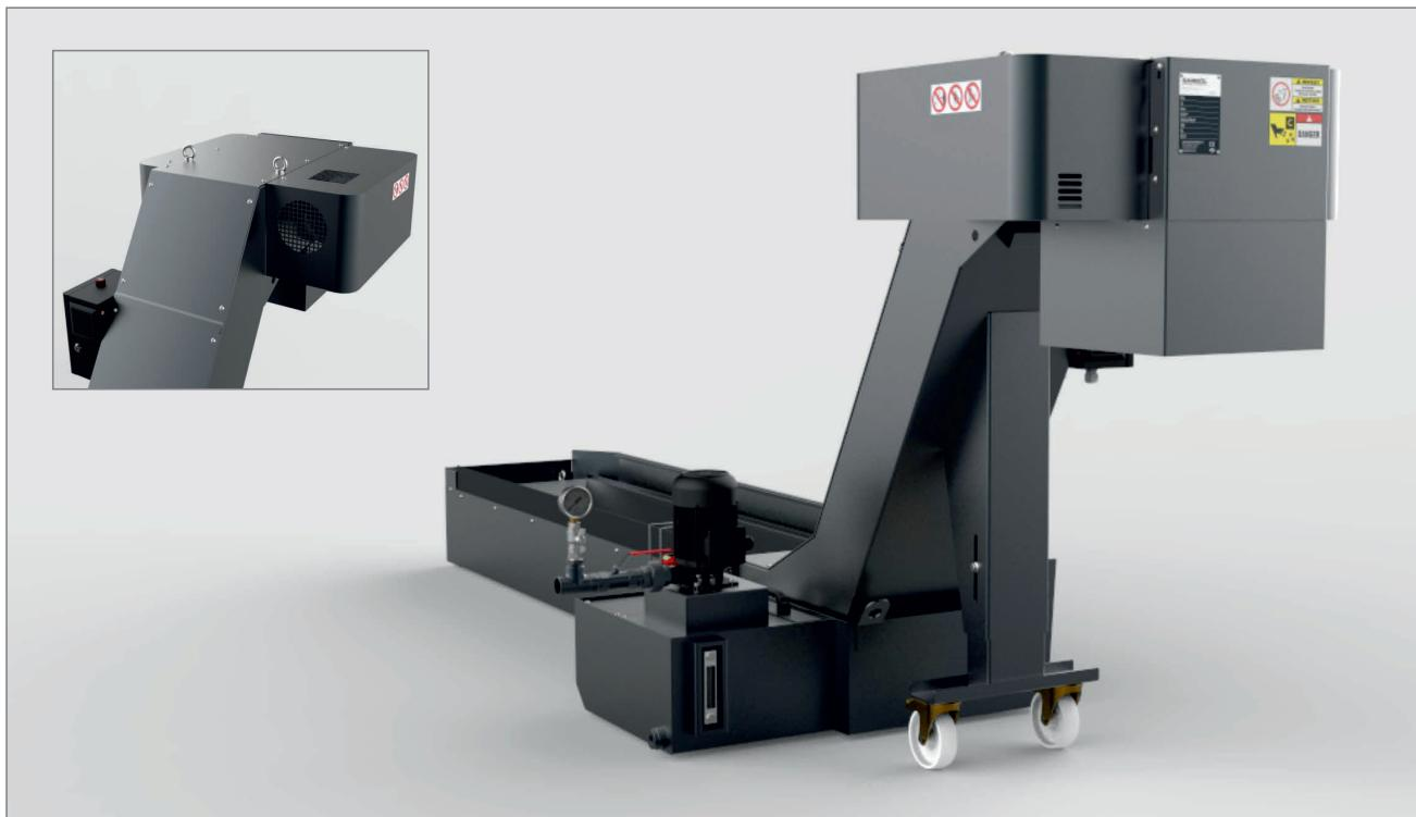
Dip kazimalı konveyörler dökme demir, pık, pirinç alaşımıları, sinterlenmiş metaller, çeşitli kompozit malzemelerin, taşlama ve honlama sonrasında çıkan toz ve kırıntı talaşlarının taşınmasında kullanılır. Kazıma yöntemi ile talaşları zemine sürterek dışarı aktarır. Konveyörün susuz çalışma durumu var ise konveyörün zemininde ve palet yollarında aşınmaya dayanıklı hardoks sac kullanılabilir.
