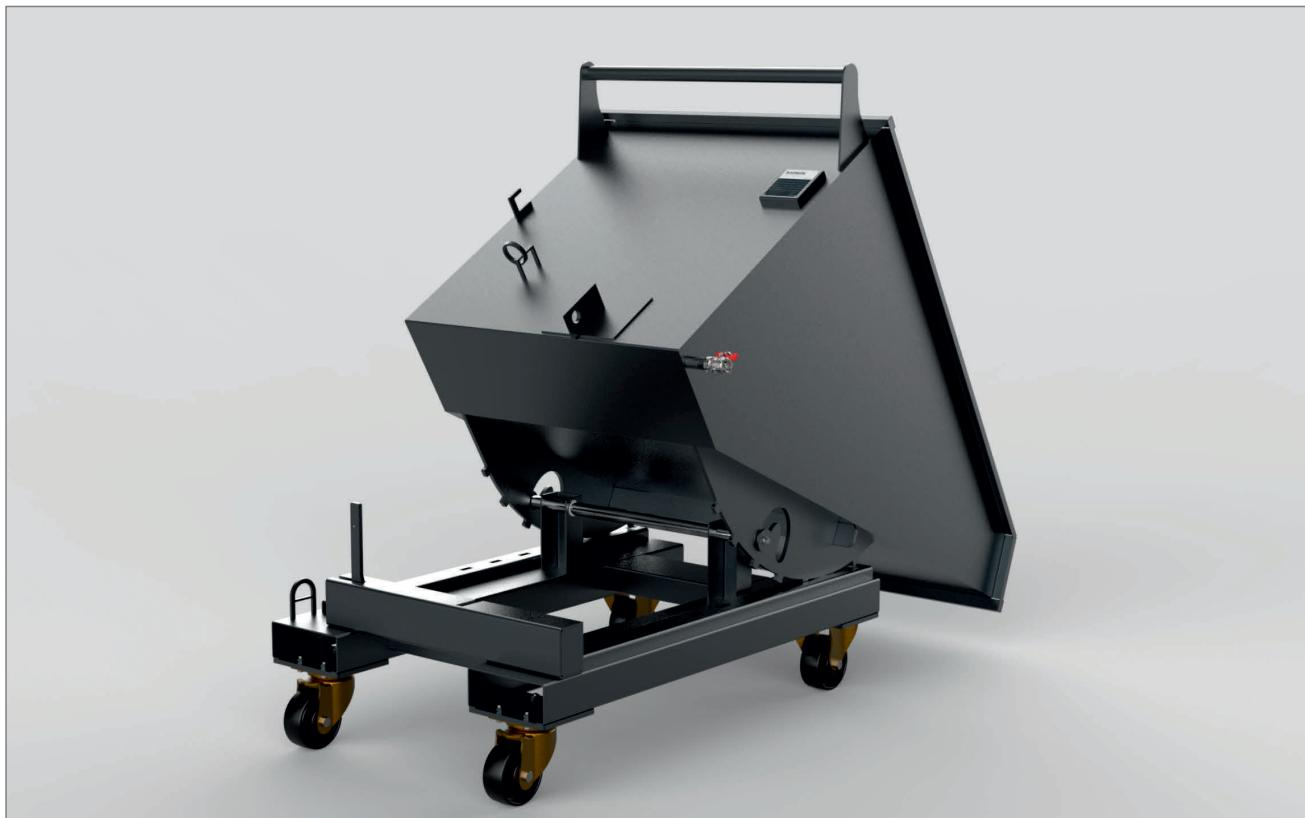
Her tür talaş konveyöründen çıkan talaşların biriktirilmesinde kullanılan, frenlenebilir, devrilebilir tekerli arabalardır. Özel dizaynı sayesinde konveyörün altından alınarak talaş deposuna rahat bir şekilde boşaltılabilir. Araba içine birikebilecek olan soğutma/kesme sıvısı tabandaki tahliye vanasından alınabilir. Farklı ölçü ve kapasitede üretimi yapılabilir.
