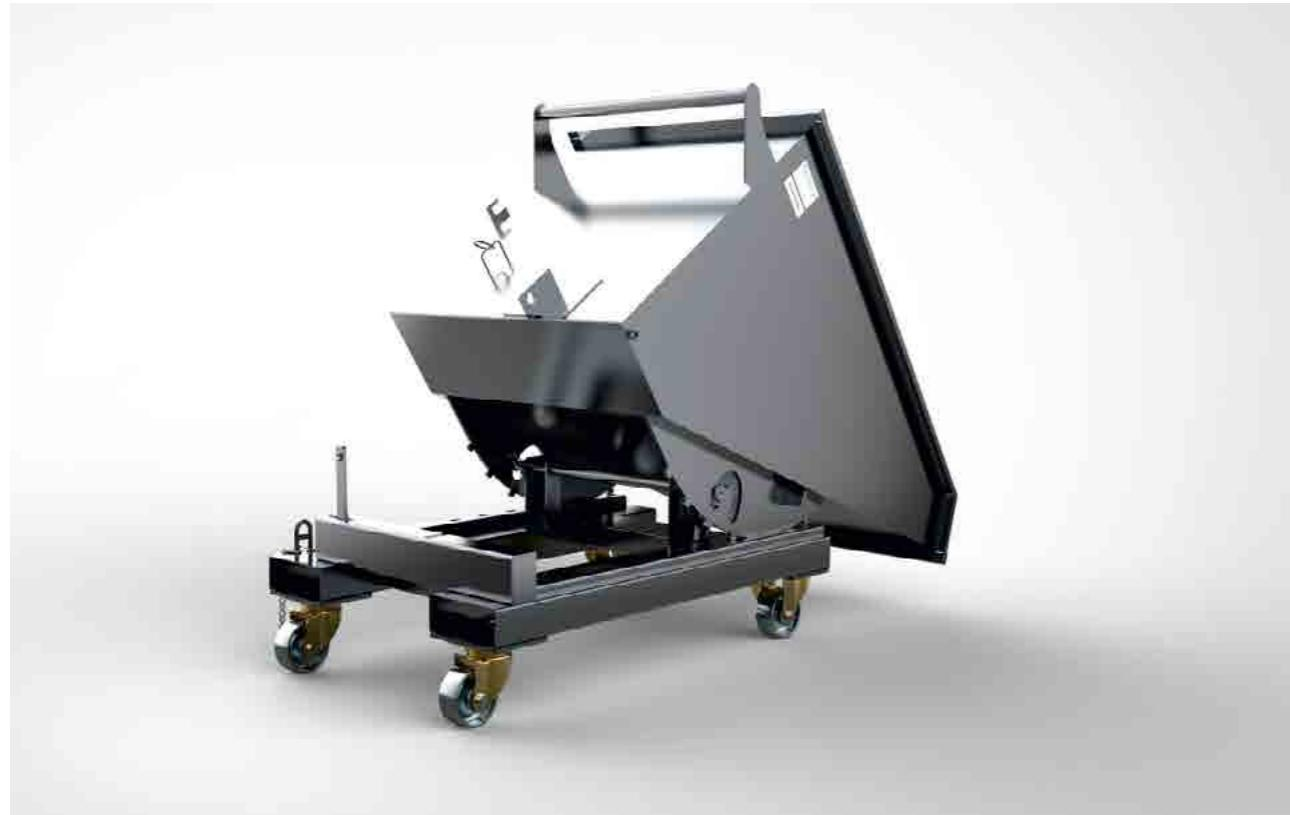
Her tür talaş konveyöründen çıkan talaşların biriktirilmesinde kullanılan, frenlenebilir, devrilebilir tekerli arabalardır. Özel dizaynı sayesinde konveyörün altından alınarak talaş deposuna rahat bir şekilde boşaltılabilir. Araba içine birikebilecek olan soğutma/kesme sıvısı tabandaki tahiye vanasından alınabilir. Farklı ölçü ve kapasitede üretimi yapılabilir.
