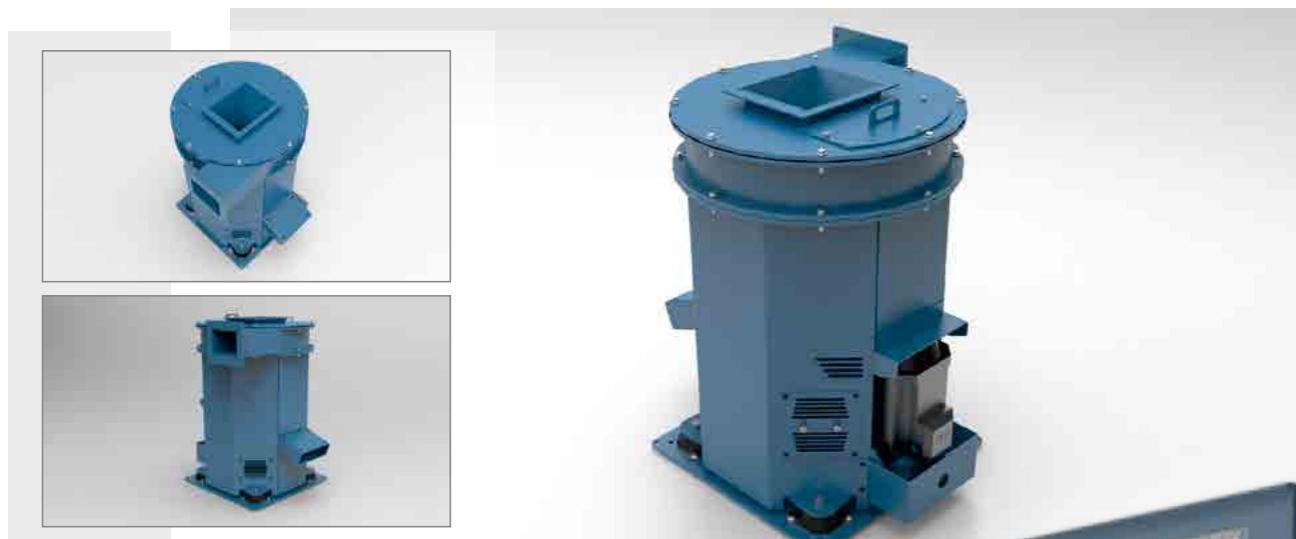
Santrifüj, talaşlı imalat atölyelerinde işlem sonrasında ortaya çıkan talaş ve soğutma/kesme sıvısı karışımının ayrıştırılması için kullanılan sistemlerdir. Soğutma/kesme sıvısı ayrıştırma sonrası tekrar filtrelenerek sisteme basılmakla geri kazanım sağlanmış olur. İşlem sonrası talaştaki nem oranı %3'ün altına indirilir. Bu oran sistemin kurulduğu yerin ortamına ve mevsim şartlarına göre değişiklik gösterebilir. Ancak ortalama şartlarda sağlanan oran %3 ve altındır.
