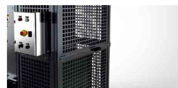
Takım tezgâhlarından çıkan talaşların, talaş arabaları vasıtıyla mevcut konteynerye veya silolara yüklenmesinde kullanılır. Zincirli talaş yükleme ve boşaltma asansörü, çelik konstrüksiyon gövdeden oluşan bir yapıya sahiptir. Asansör boyutları, istenilen ölçüde imal edilir.
