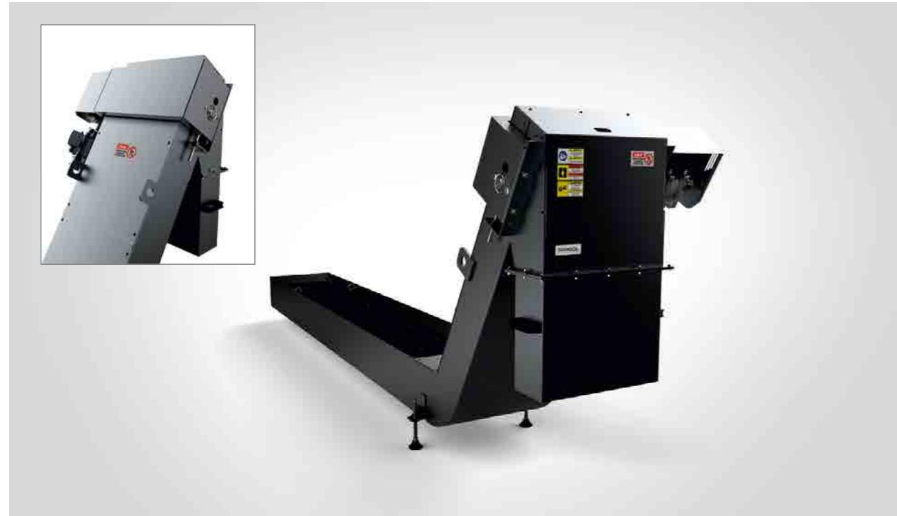
Dip kazimalı konveyörler dökme demir, pik, pırıncı alaşımları, sinterlenmiş metaller, çeşitli kompozit malzemelerin, taşlama ve honlama sonrasında çıkan toz ve kırıntı talaşlarının taşınmasında kullanılır. Kazıma yöntemi ile talaşları zemine sürerek dışarı aktarır. Konveyörün susuz çalışma durumu var ise konveyörün zemininde ve palet yollarında aşınmaya dayanıklı hardoks sac kullanılabilir.
