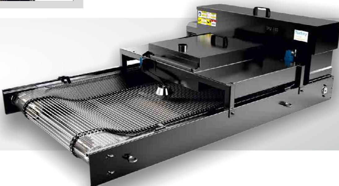
Kağıt filtreli seperatörler, talaşlı üretim ve imalat tesislerinde bulunan işleme merkezleri, temiz soğutma sıvısına ihtiyaç duyulan içten soğutmalı takım tezgâhları, taşlama tezgâhları, honlama tezgâhları, mikron seviyesinde partiküle izin veren pompa istasyonlarında kullanılmak için tasarlanmıştır.
